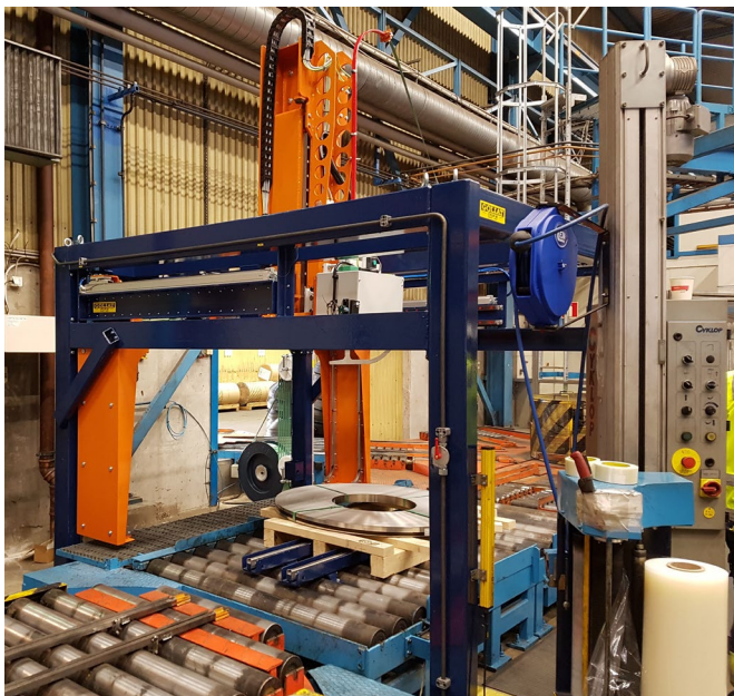
Auto bandstation med rörlig bandram för liggande coil på pall
